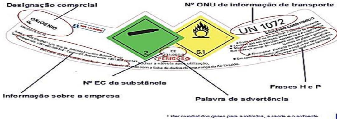
c) A etiqueta de colarinho deve estar colocada na parte superior do cilindro identificado: o nome do produto; as precauções; e, a classificação ONU do gás acondicionado. O rótulo de corpo do cilindro deve descrever as principais características do gás nele armazenado, os procedimentos de emergência e o potencial de risco:
